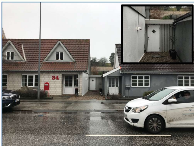
Figur 37. Boligerne skærmer for støjen, men der kommer støj ind gennem smøgen mellem de to huse. Ved at sætte et hegn (her også med en dør) i smøgen, er støjen i baghaven dæmpet mærkbart.
