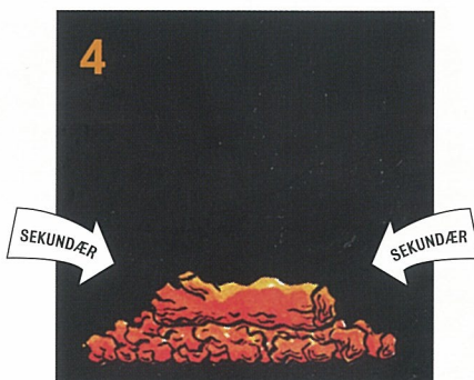
4. Efter aflusning skrues igen ned for lufttilførslen
