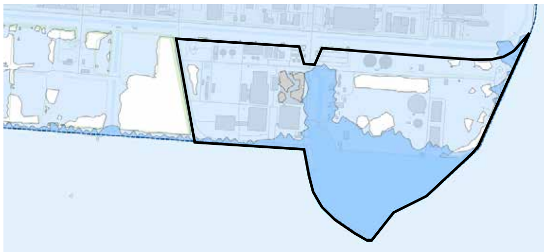
Kortet fra Kommuneplan 2021 viser udbredelse af en stormflod svarende til en 100-årshændelsen i 2115 (mørkeblå) og en 2000-årshændelsen i 2020 (lyseblå). Kortet er udarbejdet af Rambøll i 2020. Lokalplan 519s afgrænsning er vist med sort linje.
